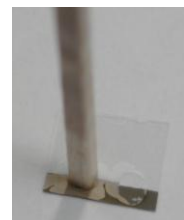
図4. ポリイミドフィルムに形成したイオンビーム直接堆積膜の剥離試験の様子。
