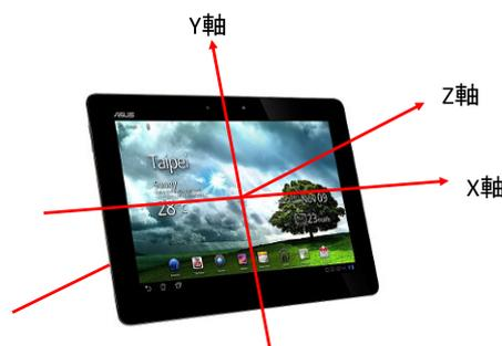
図 3.2 加速度センサから得られる Android 端末上の座標系
